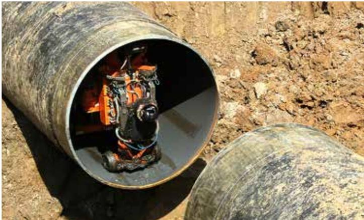
*Робот-дефектоскопист способен подстраиваться под профиль трубы*
