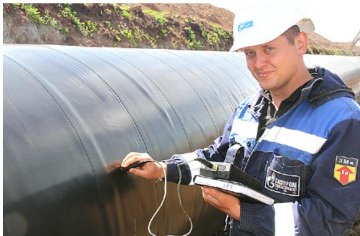
Филиус Хуснуллин замеряет толщину нового изоляционного слоя газопровода
