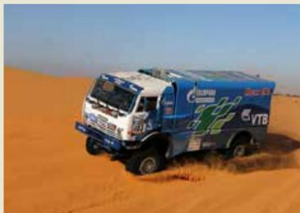
Газовый КамАЗ – специальная модель спортивного грузового автомобиля, в котором в качестве моторного топлива используется компримированный природный газ. Автомобиль создан в 2013 году командой «КамАЗ-мастер» при поддержке ПАО «Газпром» и банка ВТБ. Цель проекта: демонстрация возможностей природного газа в качестве моторного топлива.
