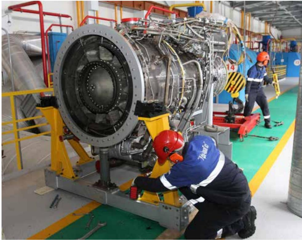
Техники по испытаниям готовят двигатель к монтажу в ячейку
