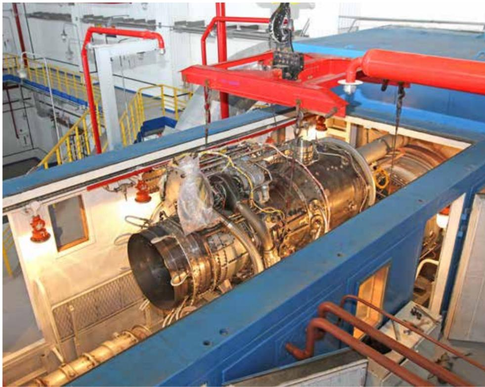
Газогенератор двигателя АЛ-31СТ вернулся в родной ГПА
