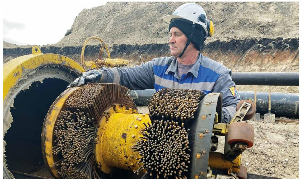
Внутритрубная диагностика газопровода Шкапово–Ишимбай
